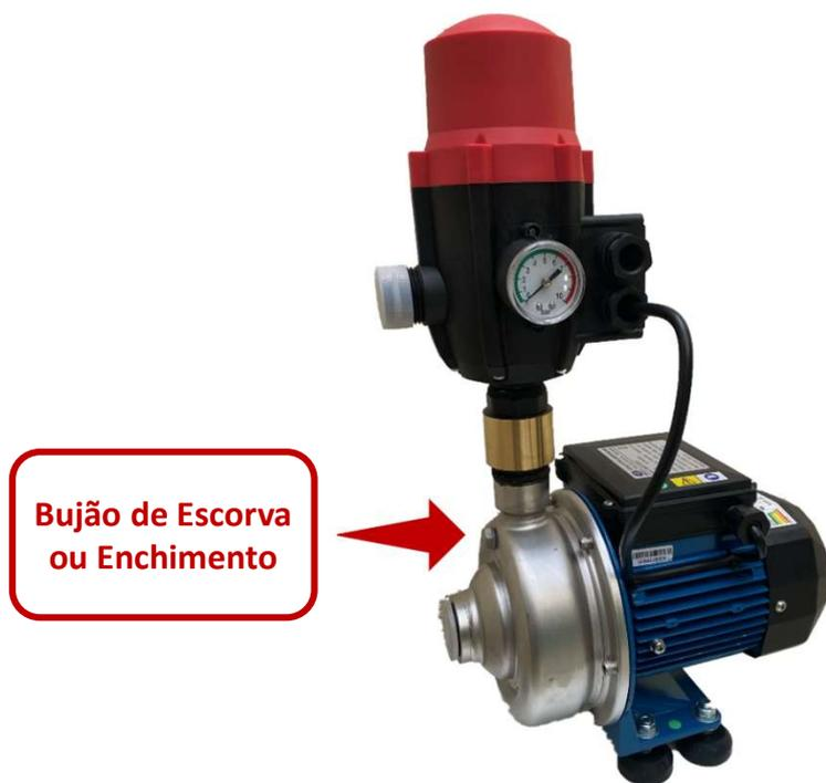
Se o equipamento estiver afogado, ou seja, o reservatório de água que irá alimentar o pressurizador estiver no mesmo nível ou acima do equipamento, basta abrir lentamente o bужão de escorva ou enchimento até que saia água e garanta que o corpo da bomba esteja cheio com água, logo após feche o bужão.
