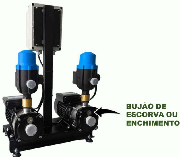
Se o equipamento estiver afogado, ou seja, o reservatório de água que irá alimentar o pressurizador estiver no mesmo nível ou acima do equipamento, basta abrir lentamente o bujão de escorva ou enchimento até que sai água e garanta que o corpo da bomba esteja cheio com água, logo após feche o bujão. Repetir o processo para ambas as bombas.
