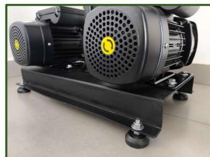
ⓘ Em caso de piso irregular pode-se fazer ajuste de nível com a regulagem de altura do vibra stop. Recomendável base 10 cm acima do piso
